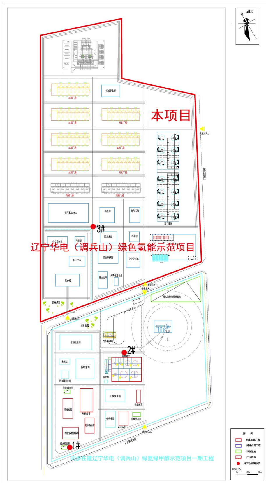
图 7-3 本项目地下水监控井位置示意图
