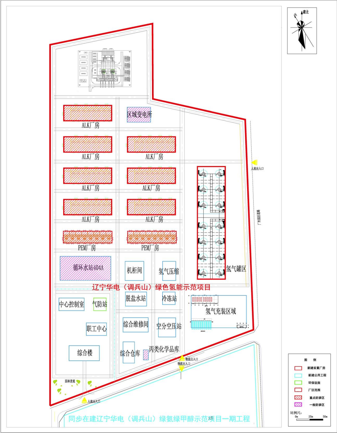
图 7-2 本项目地下水分区防渗示意图
